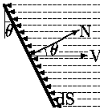
Рис. 10. Отражение света. I_r = I_p \cdot P_d \cdot \cos(Q) ,
