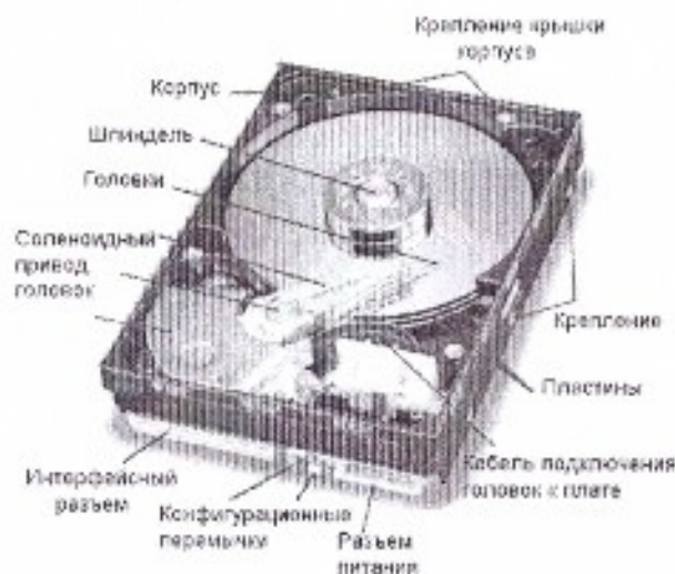
Рис. 3.1. Основные элементы накопителя на жестких дисках
