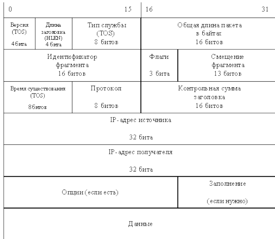
Рис. 2. Формат IP-дейтаграммы и поля заголовка.
