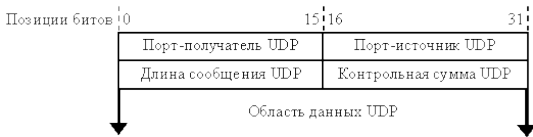
Рис. 4. Структура UDP – заголовка.
